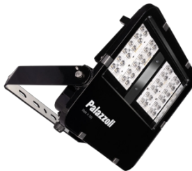
TIGUA-EX ATEX-Scheinwerfer aus Aluminiumlegierung von 6.300 lm bis 18.000 lm, IP66, Zonen 2 (GAS) und 21-22 (DUST)
