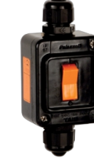
TAIS-MIGNON-EX Modularer ATEX-Kompaktschalter für den Hausgebrauch und die Industrie aus antistatischem, duroplastischem GFK, bis 16A, IP66, Zonen 2 (GAS) und 22 (DUST)
