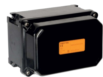
TAIS-MIGNON-EX Modularer ATEX-Kompaktschalter für den Hausgebrauch und die Industrie aus antistatischem, duroplastischem GFK, bis 16A, IP66, Zonen 2 (GAS) und 22 (DUST)
