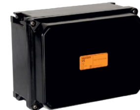
TAISBOX-EX ATEX-Gehäuse aus antistatischem, duroplastischem GFK mit undurchsichtigem Deckel, IP66, Zonen 1-2 (GAS) und 21-22 (DUST)
