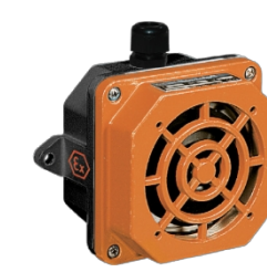
TAISBOX-EX ATEX-Gehäuse aus antistatischem duroplastischem GFK mit höherer Schutzart, IP66, Zonen 1-2 (GAS) und 21-22 (STAUB)
